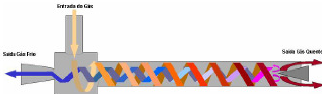
FIGURA II Esquema de funcionamento do TUBO VORTEX SEPARADOR®
